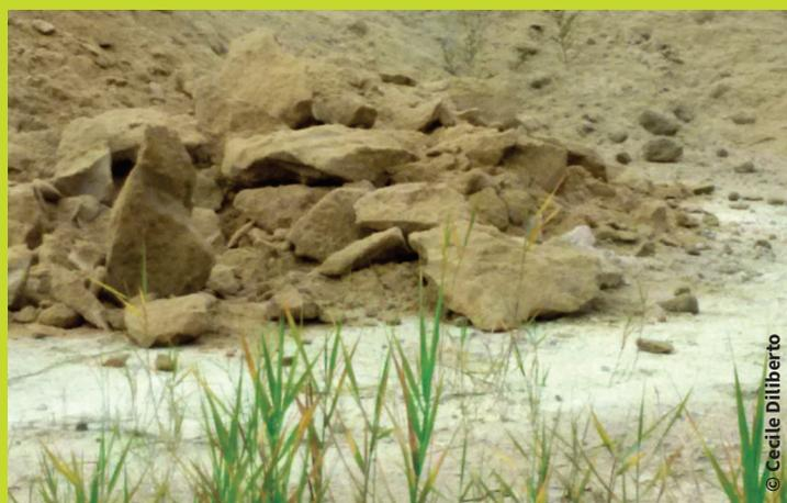
*Le laitier de hauts fourneaux est un déchet utilisé en substitution du clinker.*
